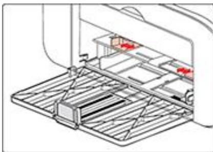
c) Levante a bandeja de saída de papel, para evitar o deslizamento do papel.
