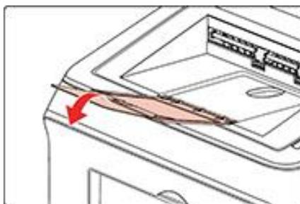
d) Coloque através de ambas as mãos um envelope ou um filme transparente, entre outras mídias de impressão na bandeja de alimentação manual até que a extremidade frontal do envelope ou filme transparente toque na faca de correção.
