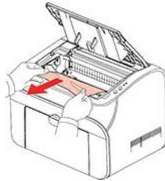
6. Depois de retirar o papel parado, coloque o cartucho de toner laser ao longo dos trilhos para a impressora, a instalação termina quando um som de "Ka" é ouvido.
