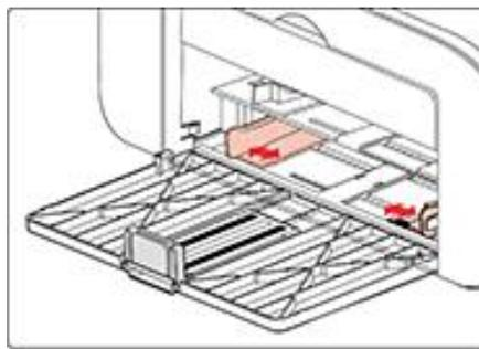
c) Levante a bandeja de saída de papel, para evitar o deslizamento do papel.
