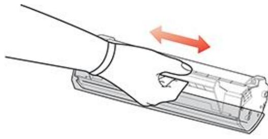
3. Retire a tampa protetora do cartucho de toner para laser (cobertura de absorção de plástico), colocando o cartucho de toner para laser na impressora ao longo dos trilhos de guia, pressione ao longo da direção de seta até que ouça um "clique", concluída a instalação.
